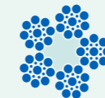
■ Drahtseil mit Fasereinlage (FC)
