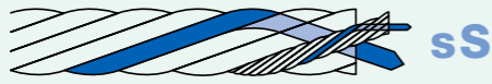
■ Parallelverseilt: Gleichschlag linksgängig ■ Câblage parallèle: câblage long à gauche ■ Parallel strands: left-hand long lay
