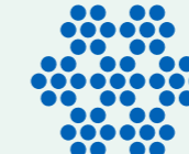
■ Drahtseil mit Stahleinlage (WC)
